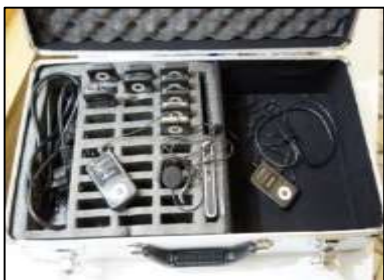
Цифровая система «Радиогид» с индукционной петлей
